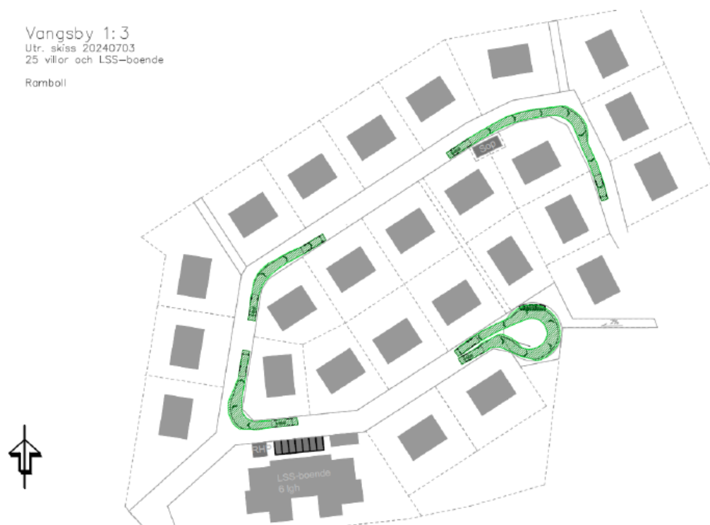
Figur 23 - Körspårsanalys för typfordon LOS, Ramboll.
