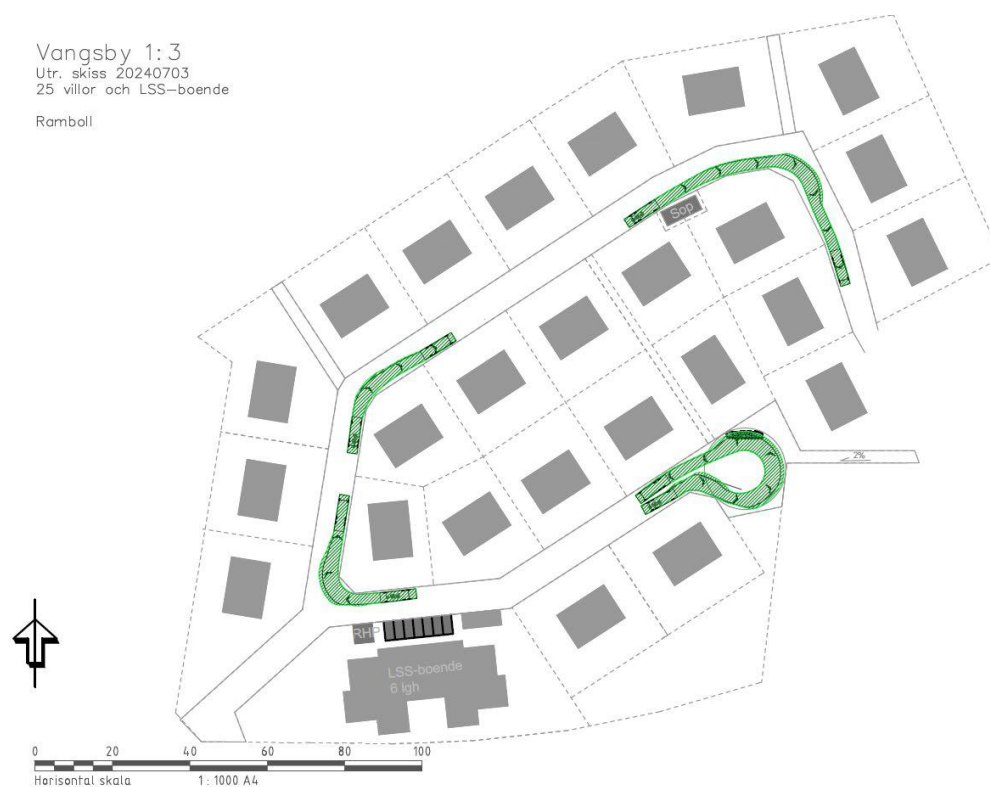
Figur 10 - Körspårsanalys för fordonstypen LOS (sopbil), Ramboll.
