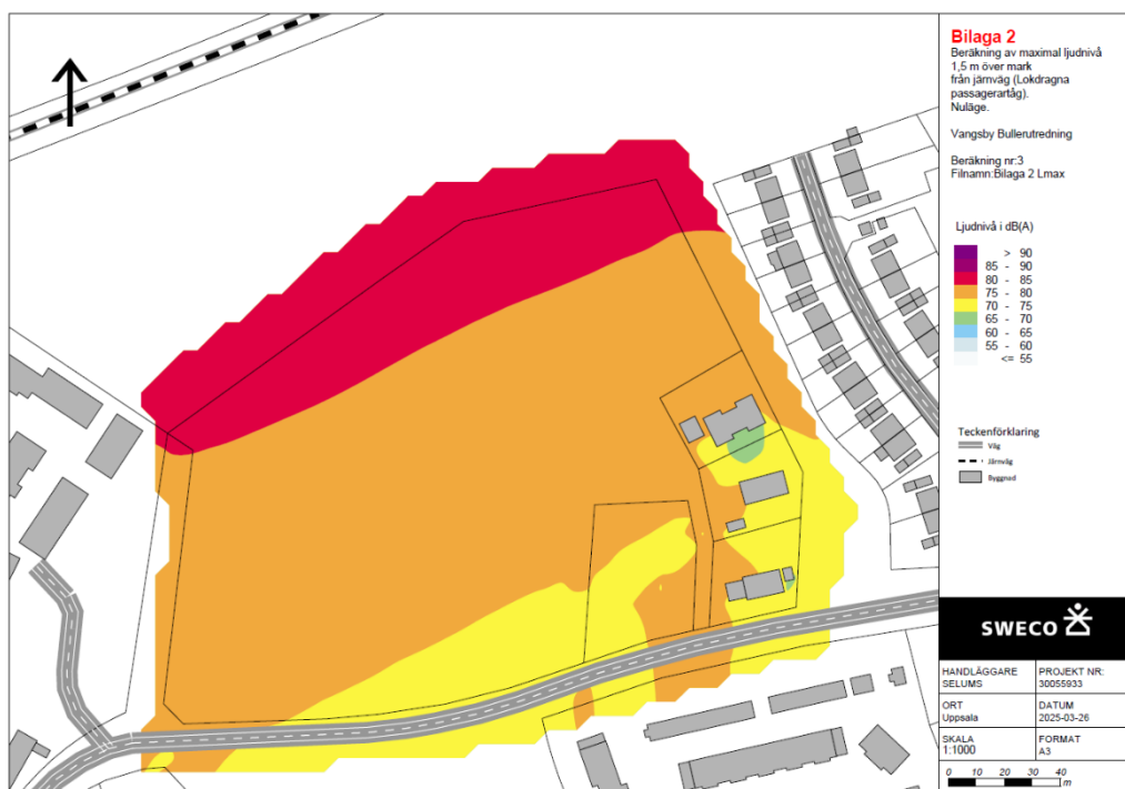
Figur 15 - Beräkning av maximal ljudnivå från lokdragna passagerartåg, nuläge, Sweco.
