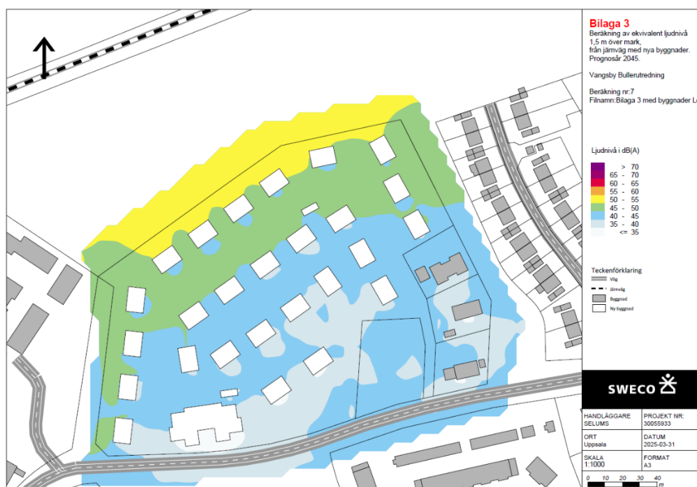
Figur 18 - Beräkning av ekvivalent ljudnivå med nya byggnader, prognosår 2045, Sweco.
