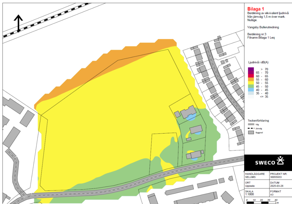
Figur 14 - Beräkning av ekvivalent ljudnivå från järnväg, nuläge, Sweco.
