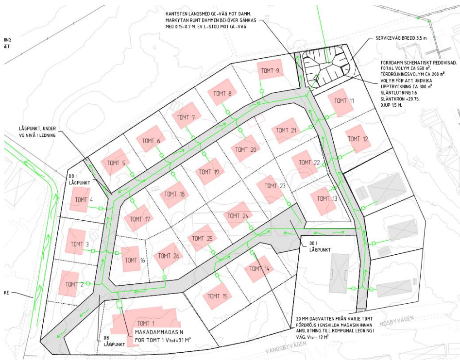
Figur 24. Föreslagen systemlösning för dagvattenhantering i området.
