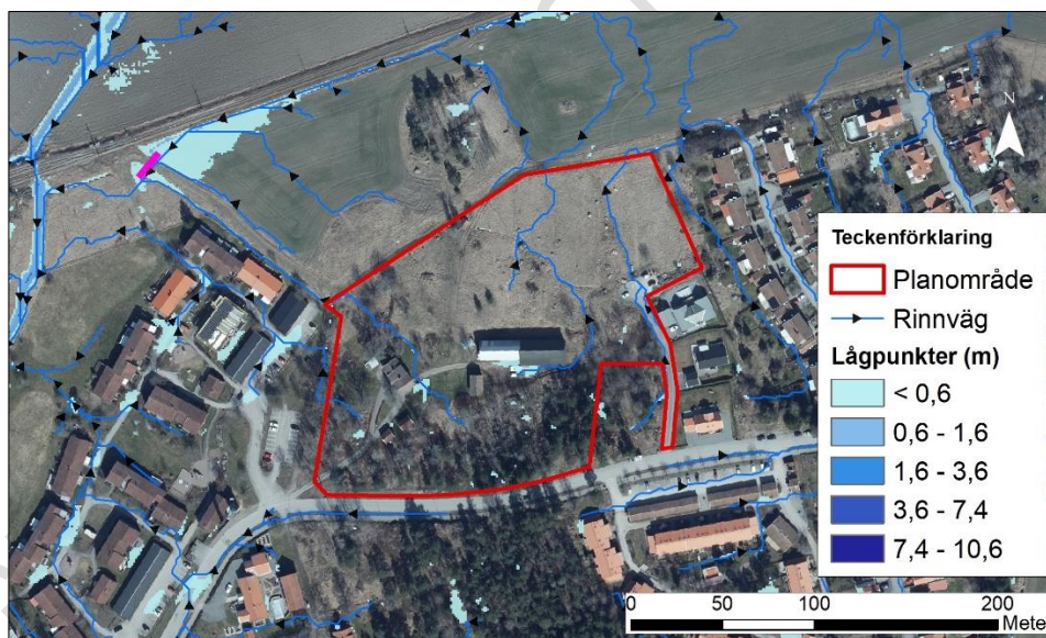
Figur 16. Vattendjup i lokala lågpunkter inom och i anslutning till planområdet vid kraftig nederbörd (68 mm, motsvarande något mer nederbörd än ett klimatkompenserat 100-årsregn med varaktighet 60 minuter enligt RCP 8.5 och klimatperiod 2071–2100). Lila markering indikerar trumma. Bakgrund: Ortofoto från Lantmäteriet.
