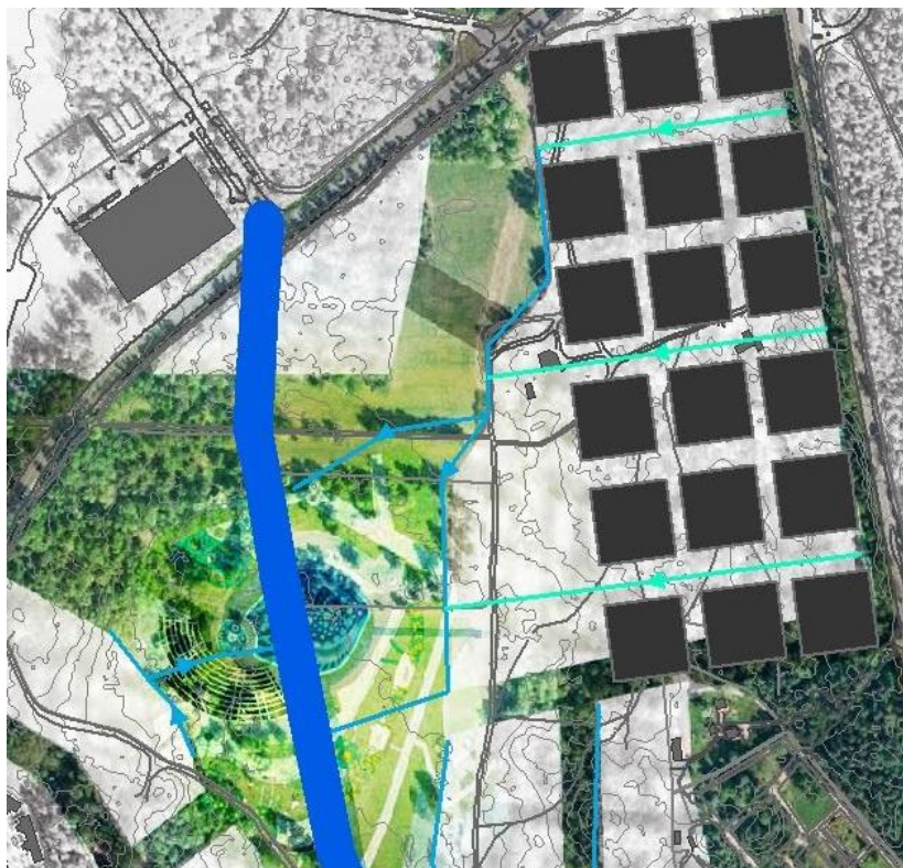
Figur 2. Schematisk illustration över dagvattensystemets huvudkomponenter. Ljus blå/grön är lokala stråk. Blå är uppsamlingsstråk. Tjock mörkblå är Centrala stråk (Bäcklösa i bilden). Svarta fält symboliserar kvartersmark.
