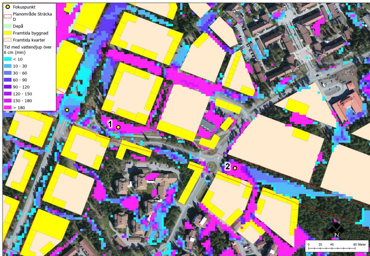
Figur 5-37 Tid då det beräknas stå vatten med ett vattendjup på minst 6 cm vid studerat 100-årsregn för området för etapp 1 och 2 som inte är i direkt anslutning till depån. Fokuspunkterna är placerade på spårvägen och ny väg vid framtida bebyggelse.
