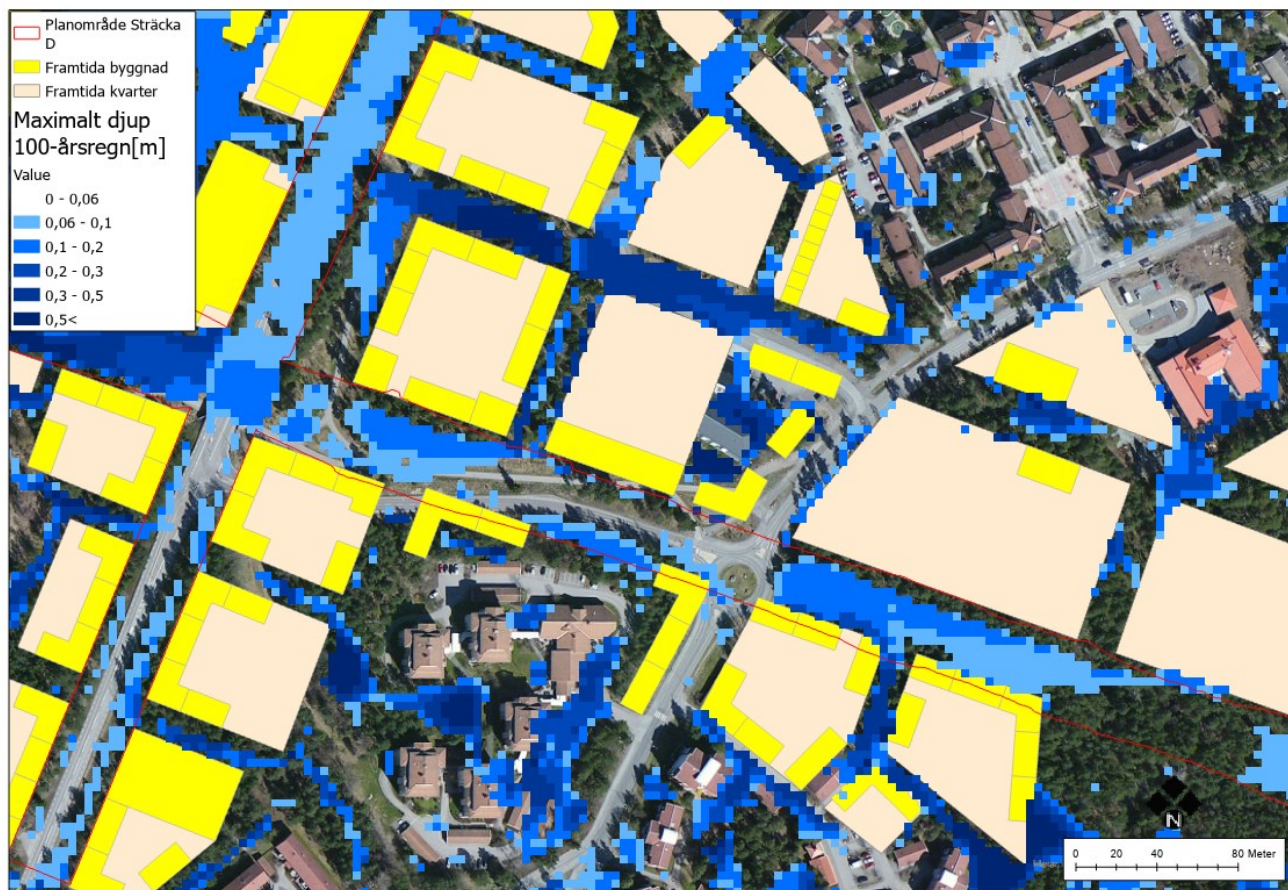
Figur 5-24. Spårvägen får ett maximalt vattendjup på upp till 0,2 meter. Vägen i anslutning till den föreslagna bebyggelsen får ett maximalt djup på upp till 0,6 meter.
