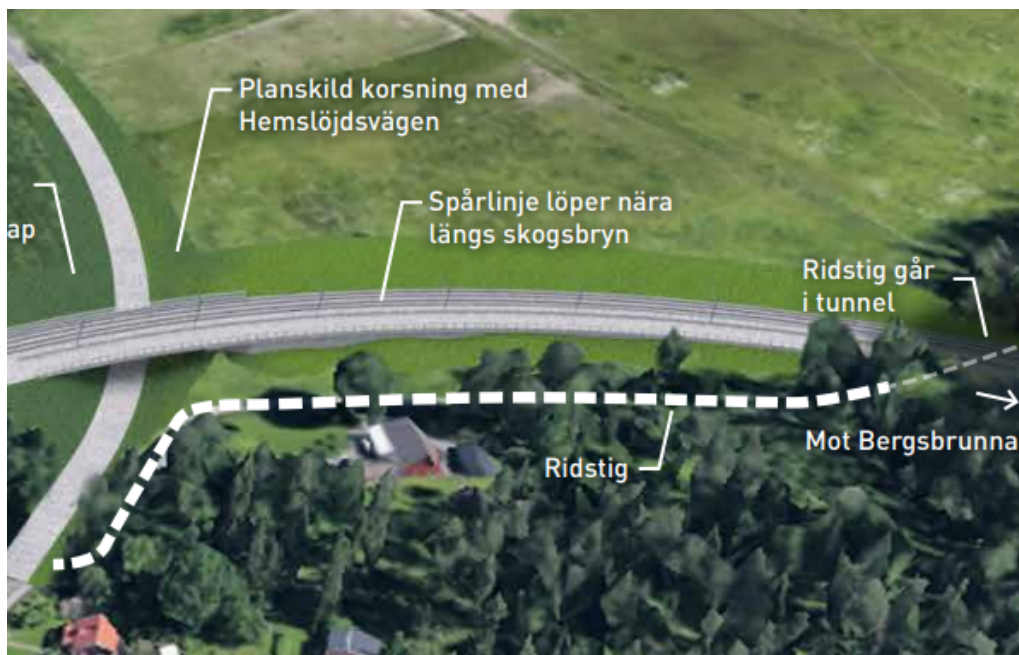
Bild 22. Illustration av banans korsningen med Hemslöjdsvägen och ridstigen. Bild av Bjerking och Rundquist.
