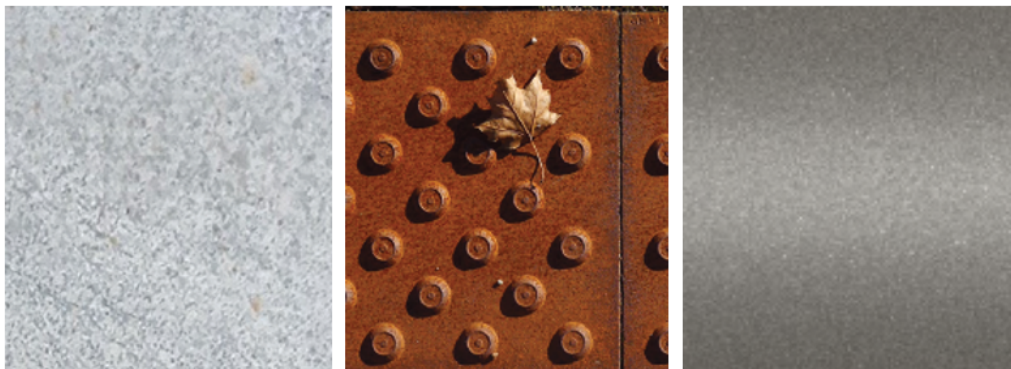
Bild 41. Exempel på tre materialval för hållplats och väderskydd. Från vänster visar den första bilden ljus granit, bilden i mitten visar gjutjärn och bilden längst till höger visar ett exempel på pulverlackerat stål. Dessa material kan vid hållplatser och väderskydd kombineras med till exempel trä och glas. Bilder: White arkitekter.
