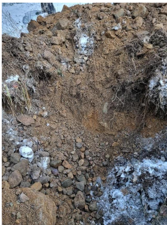
T.h. Moränmark, inslag av större block djupare i profilen.
