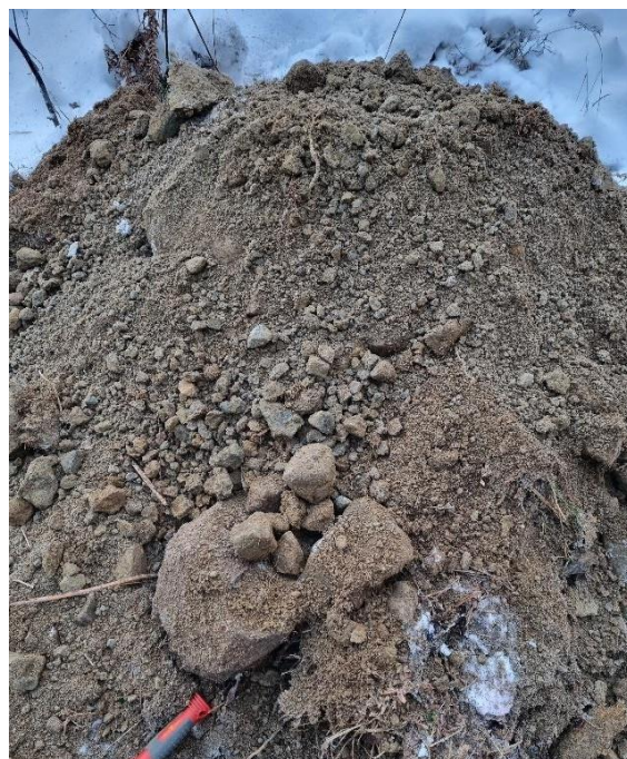
T.h. Moränmark, inslag av större block djupare i profilen.
