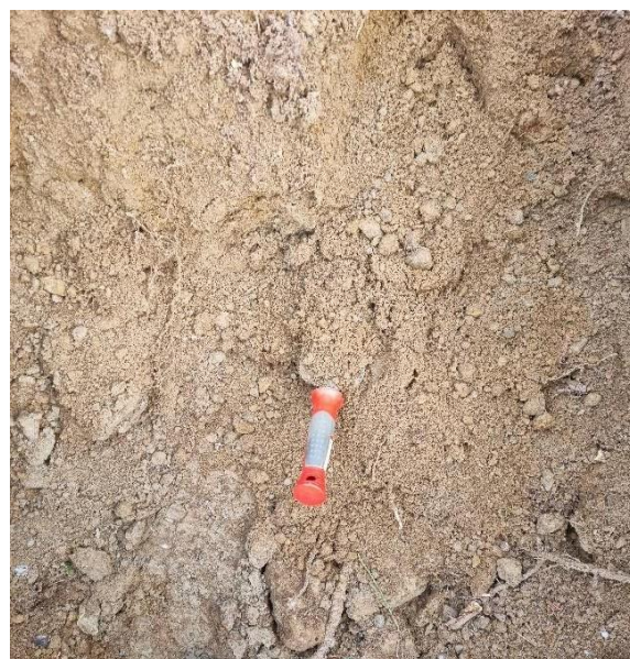
T.h. Moränmark, finfördelad sand. Delvis sammanbunden pga tjäle.
