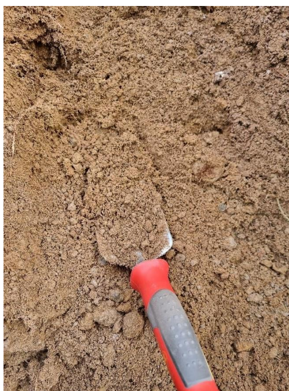
T.h. Moränmark, finfördelad sand. Delvis sammanbunden pga tjäle.
