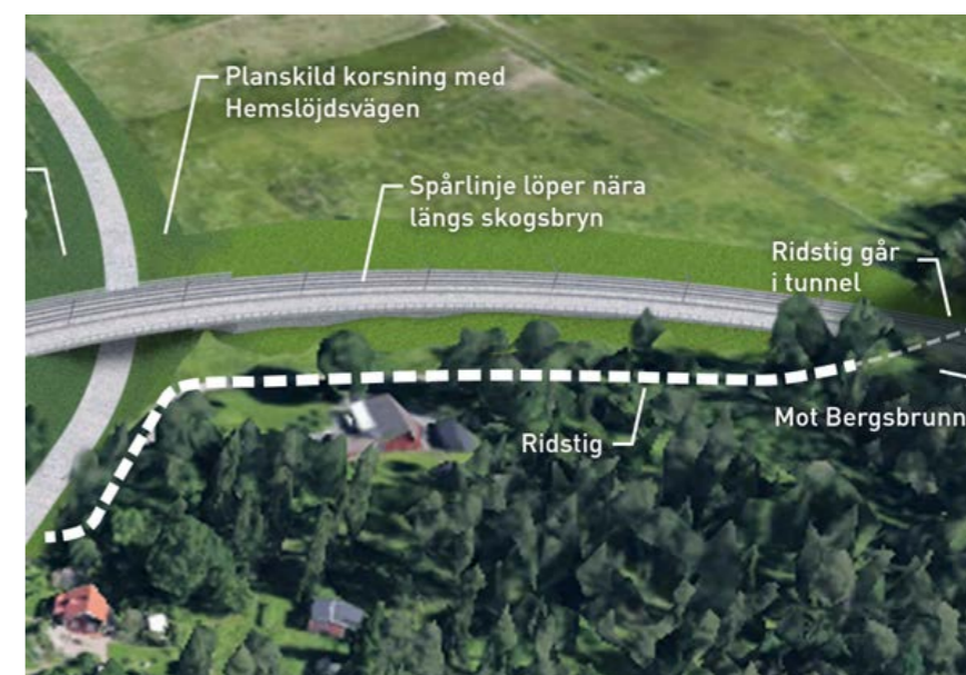
Figur 17. Illustration av kollektivtrafikstråkets korsning med Hemslöjdsvägen och ridstigen. Källa: Bjerking/Rundquist, Broar Ultuna-Hemslöjdsvägen: Underlag till detaljplan för kapacitetsstark kollektivtrafik Delsträcka D, 2023-04-24.
