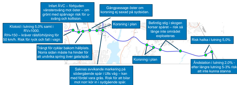
Figur 22 Delsträcka D – platser med risk för personskada (uppdaterad 20240122)
