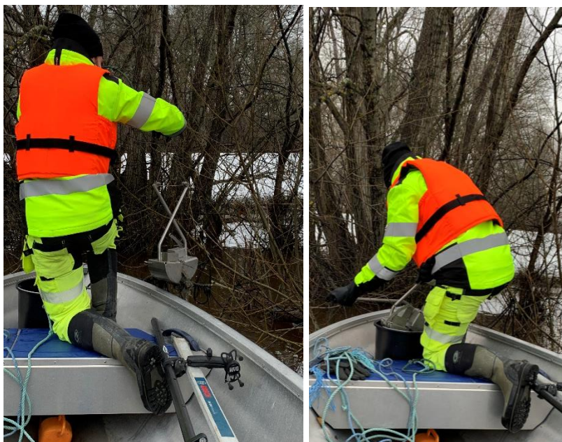
Figur 4. Provtagningsförfarandet. På grund av mycket grenar fick huggaren nedsänkas och tömmas 4–5 gånger per provpunkt.
