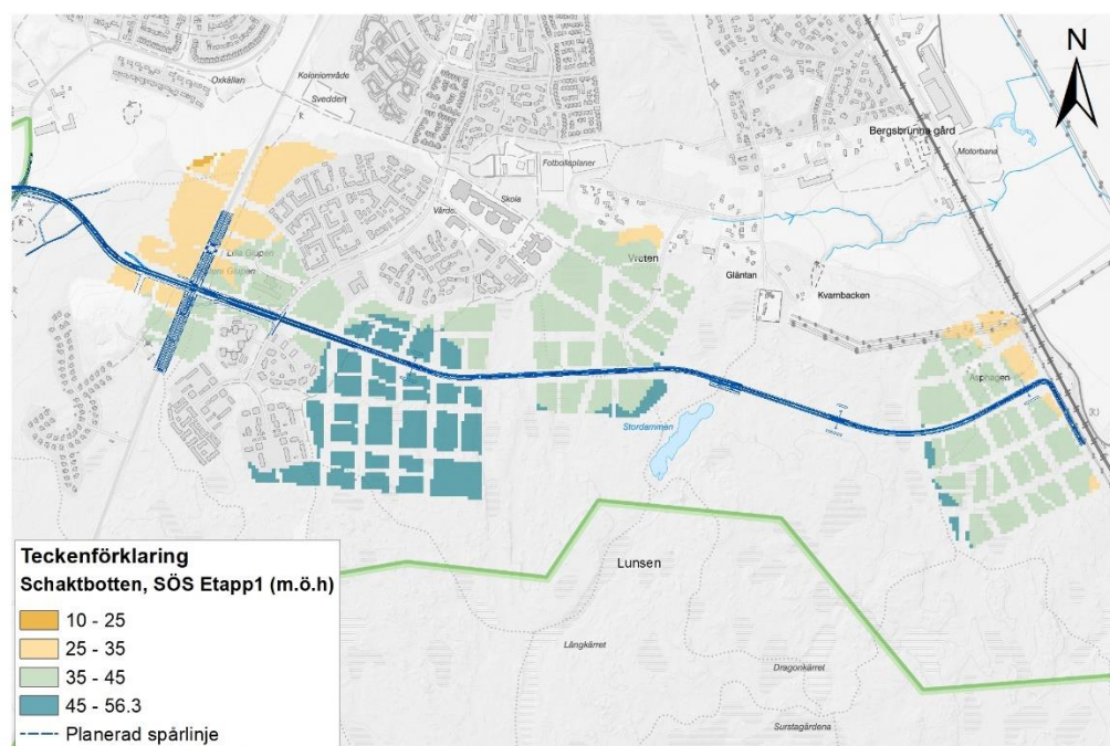
Figur 14. Planerad schaktbotten för SÖS olika kvarter (etapp 1) samt spårvägens dragning.
