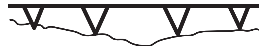
Alternativ 4 - flerspannsbro med fyra mellanstöd.
