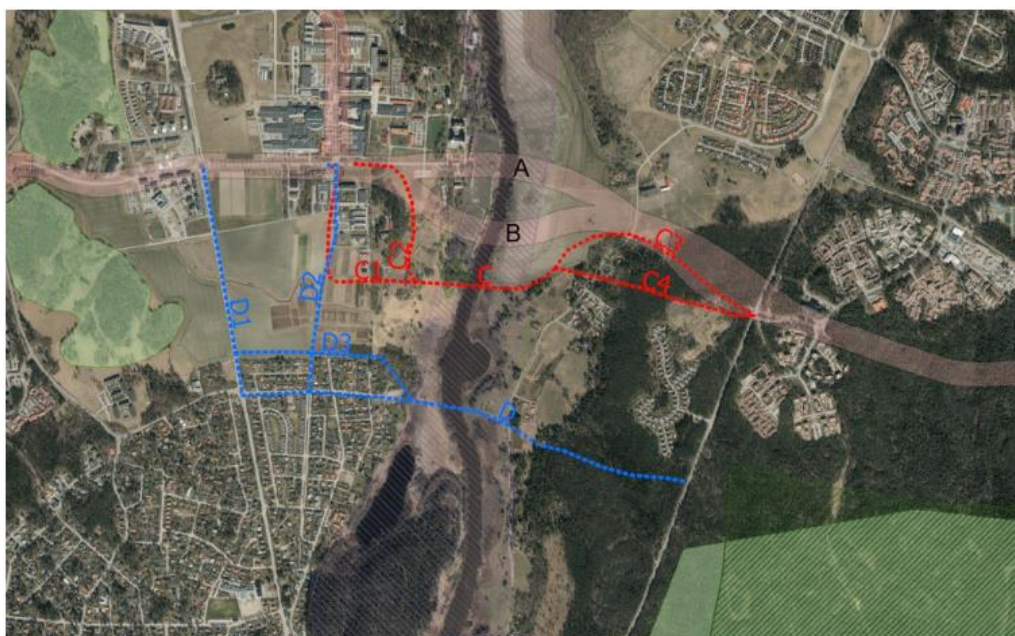
Figur 21 Schematisk redovisning av brolägen på ortofoto. Broläge A och B presenterades i detaljplanen för kapacitetsstark kollektivtrafik (hela sträckan A-D) samrådshandling 2021. Broläge C och D har utretts därefter.
