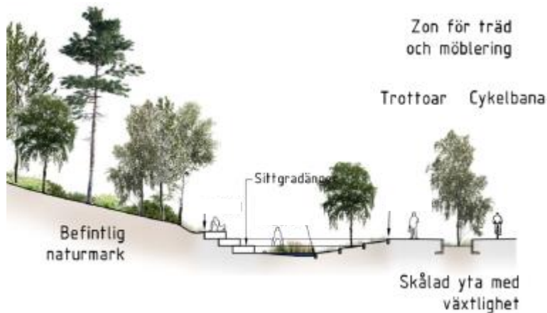
Figur 19. Exempel på sektion för skyfallshantering med sittgradänger, trottoar och cykelbana där ytor tillåts översvämma vid skyfall. (Illustration: Urbio)
