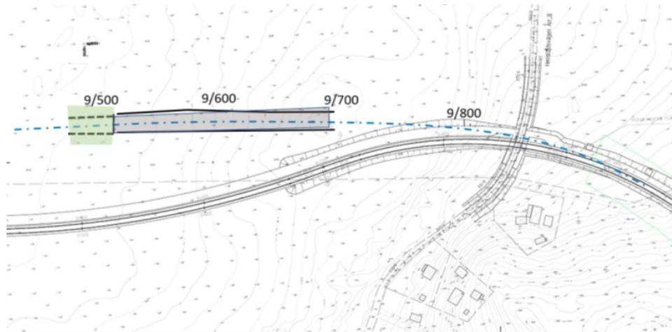
Figur 13. Placering av tunnel och tråg för alternativ TUB, öster om ån.
