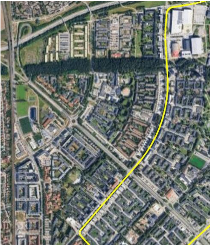
Figur 3.53. Längs Råbyvägen mittförläggs spårvägen.
