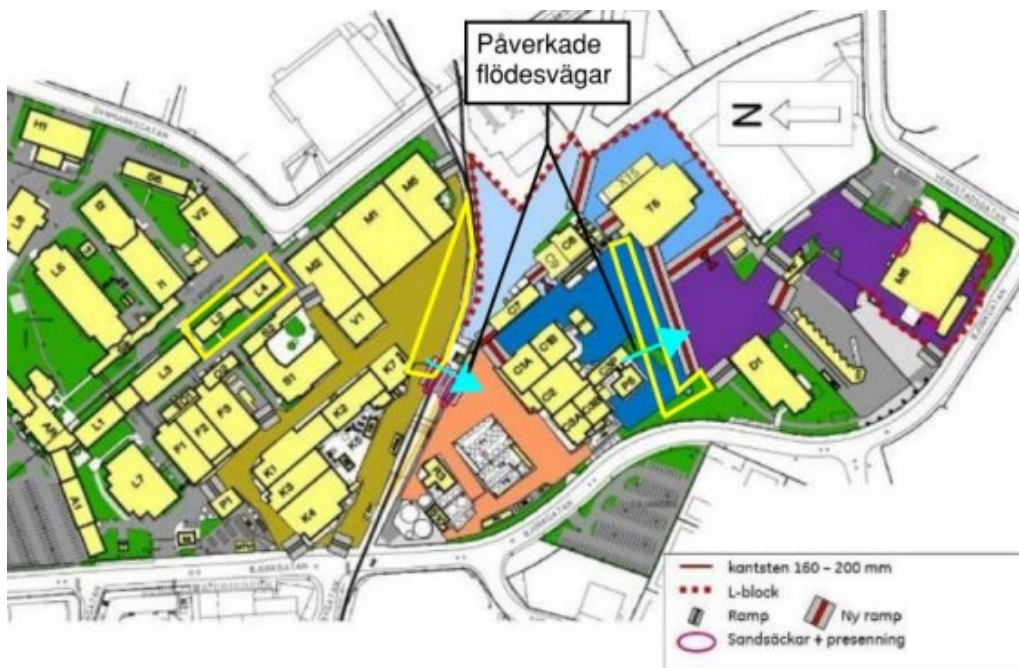
Figur 17 Påverkade rinnvägar för dagvatten, markerade med blå pilar. Källa: Cytiva Sweden AB
