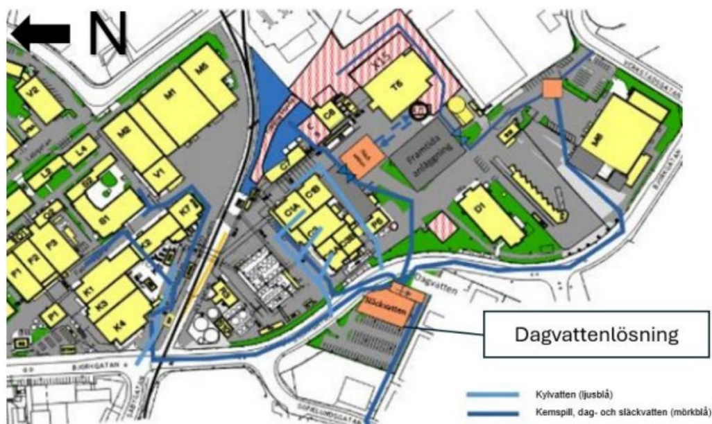
Figur 14 Kartbilden visar hur separation av dag- och kylvatten är tänkt att ske. Källa: Cytiva Sweden AB
