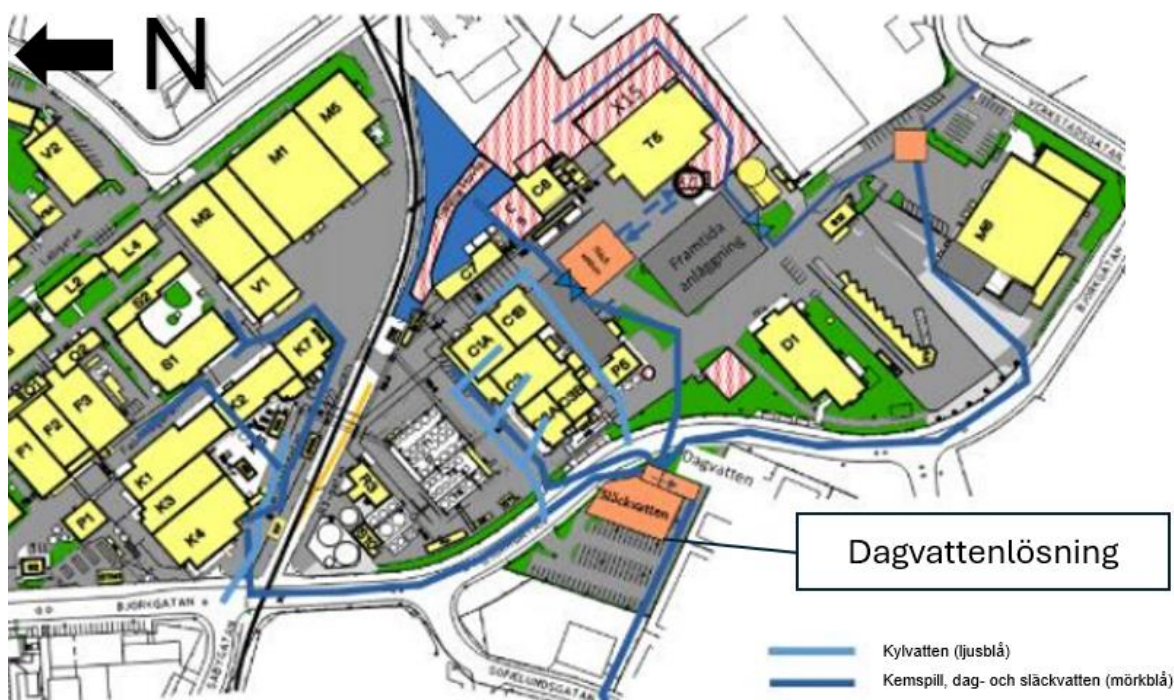
Figur 11. Separation av dag- och kylvatten. Bild tagen från provotidsredovisning, Cytiva 2021.
