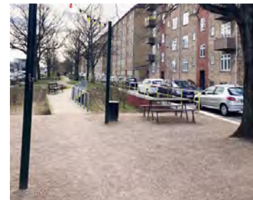
Stenmjöl utgör ytskikt i gångvägar, angöringsgata och parkens entréytor.
