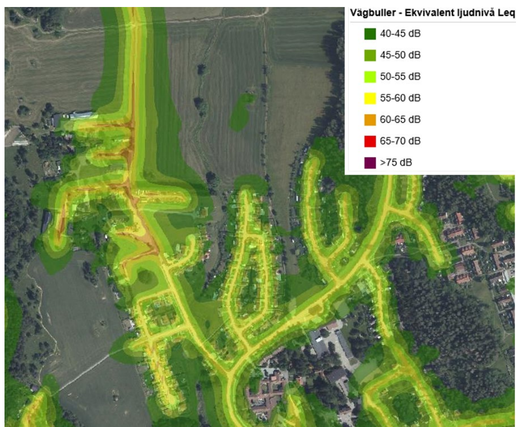
Figur 27 Utdrag ur Uppsala kommuns bullerkartläggning/simulering från 2017.
