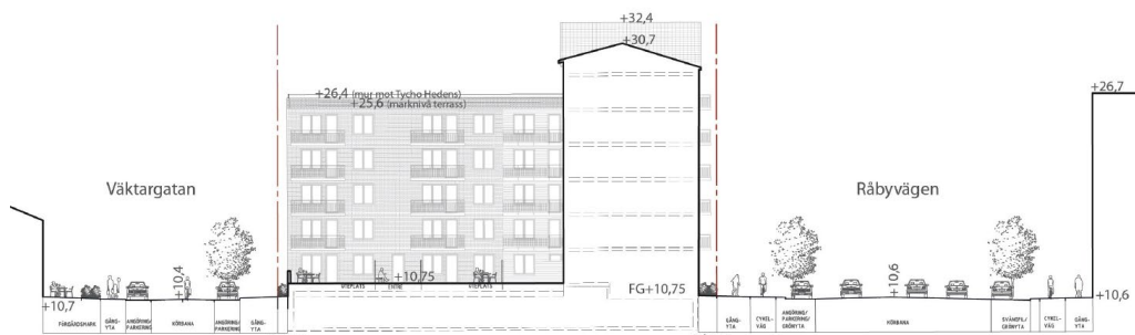
Figur 11. Sektion längs kvarteret, med Våktargatan till vänster och Råbyvägen till höger. Sektionen går igenom gården, det underjordiska garaget, och byggnaden mot Råbyvägen. I bakgrunden syns byggnaden mot Tycho Hedéns väg (skiss: Archus).
