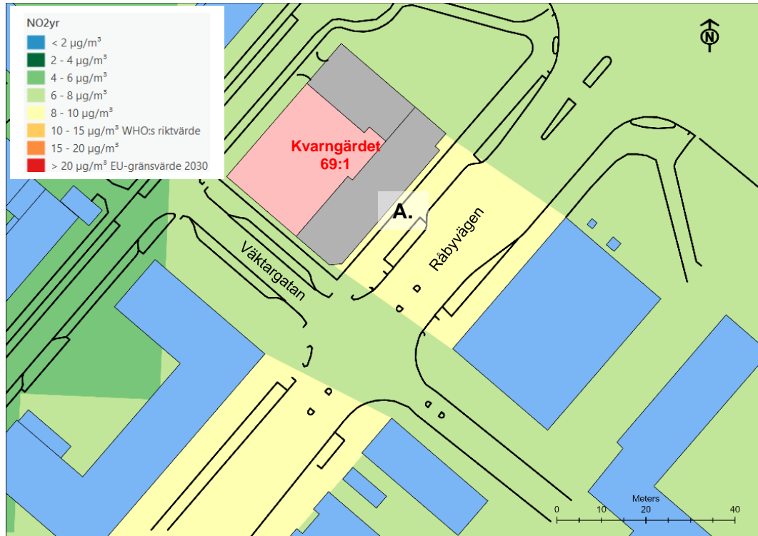
Figur 14. Årsmedelvärden av halter kvävedioxid NO 2 i µg/m 3 i utbyggnadsalternativet år 2030 relaterade till EU-gränsvärdet. Planerad bebyggelse vid Kvarngärdet 69:1 visas med grå polygoner. Haltskalan är anpassad till EU-gränsvärdet som ska klaras från år 2030.
