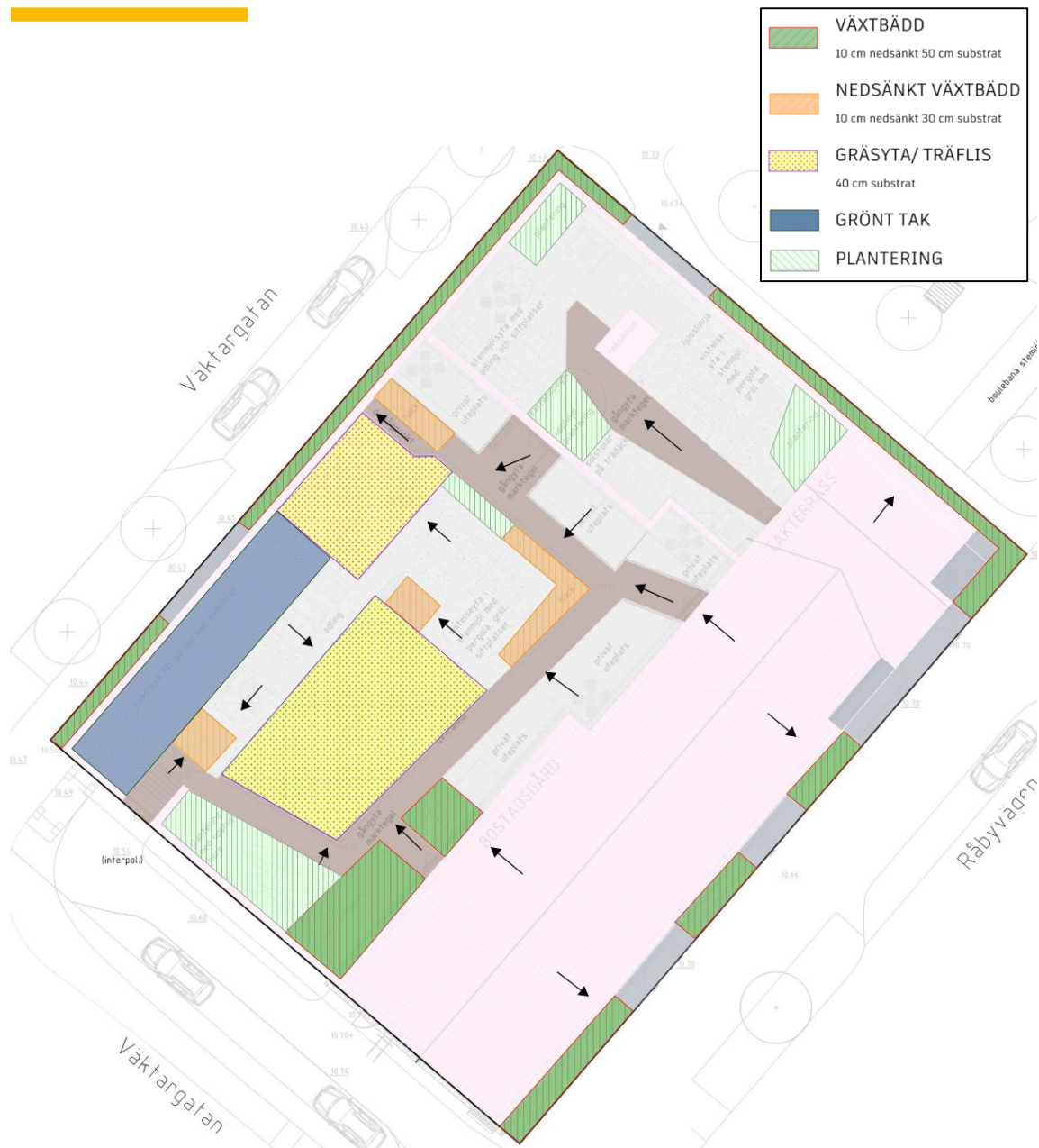
Figur 5-1. Systemlösning med rinnriktningar och markering för dagvattenanläggningar.
