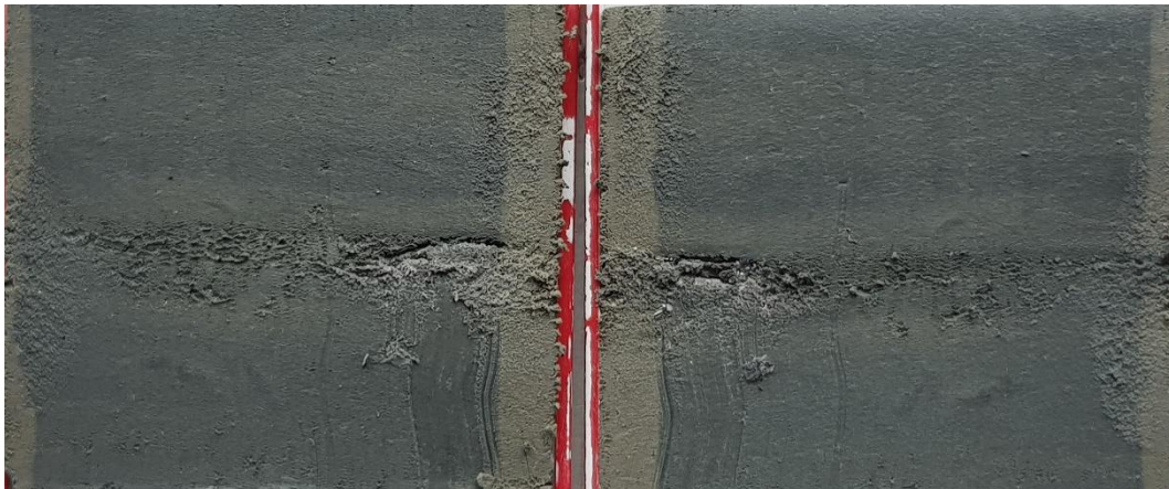
Figur 3 Borrpunkten, 22W01, 8,0 m, Jordprovet i nedre delen av mellanhylsan delad longitudinellt provhylsan med id Bjerking 1285.
