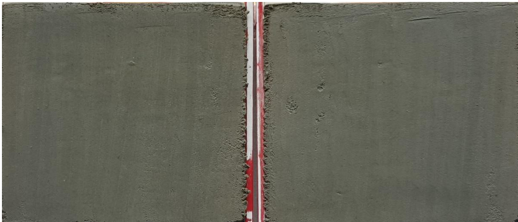
Figur 2 Borrpunkten, 22W01, 5,0 m, Jordprovet i nedre delen av mellanhylsan delad longitudinellt provhylsan med id Bjerking 876.
