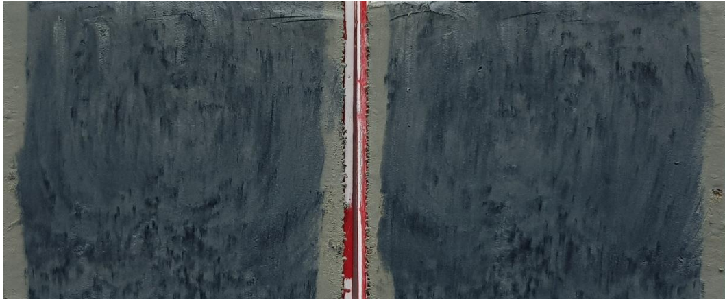
Figur 4 Borrpunkten, 22W01, 12,0 m, Jordprovet i nedre delen av mellanhylsan delad longitudinellt provhysan med id Bjerking 1123.
