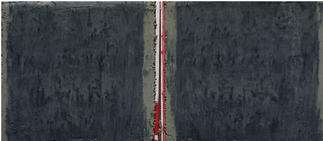
Figur 8 Borrpunkten, 22W07, 12,0 m, Jordprovet i nedre delen av mellanhylsan delad longitudinellt provhylsan med id Bjerking 1043.
