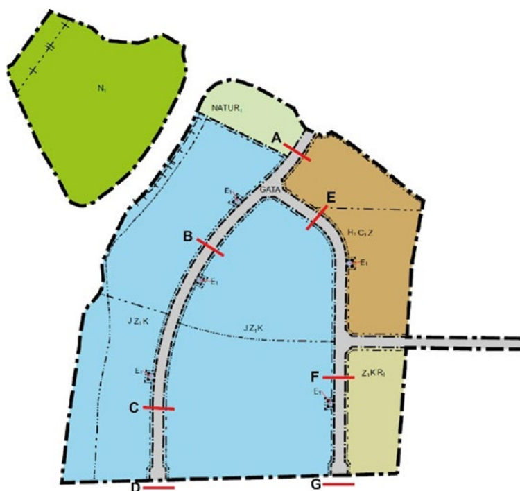
Bild 19 Beräknade trafikmängder vid ett fullt utbyggt område, fordon/dygn (ÅDT- årsmedeldygnstrafik) och trafikmängd tung trafik (årsmedeldygnstrafik tung). Andelen tung trafik bedöms vara 15 %.
