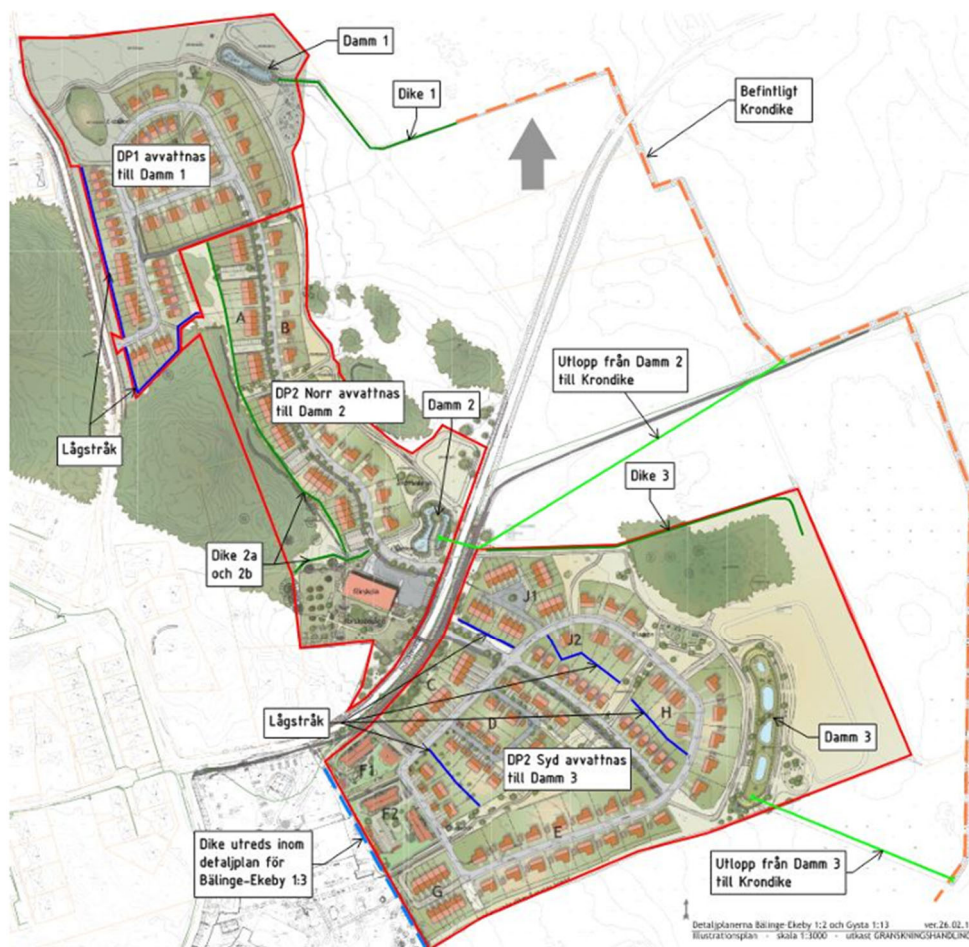
Bild 38 Förslag till dagvattenhantering inom planområdena. Bilden visar nya dammar, diken (mörkgrön linje), lågstråk (blå linje) och utloppsledningar (ljusgrön) inom planområdena. Structor med illustrationsplan från Reierstam Arkitekter & Projektutveckling.
