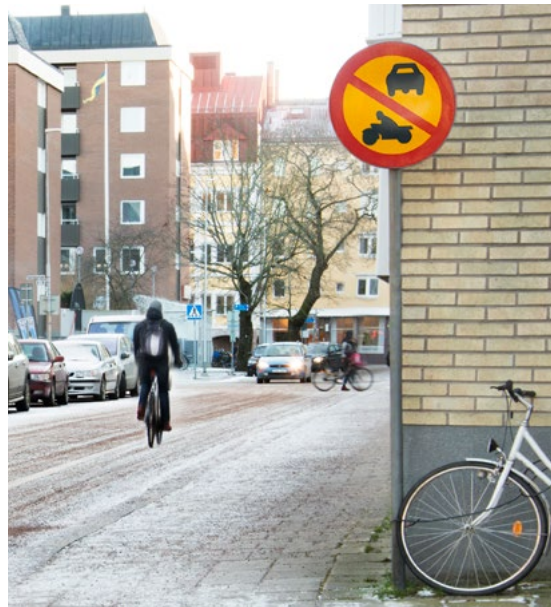
Exempel på gata (Sturegatan) reglerad med förbud mot trafik med motordrivet fordon i den ena riktningen medan cyklister tillåts cykla i båda körriktningarna.
