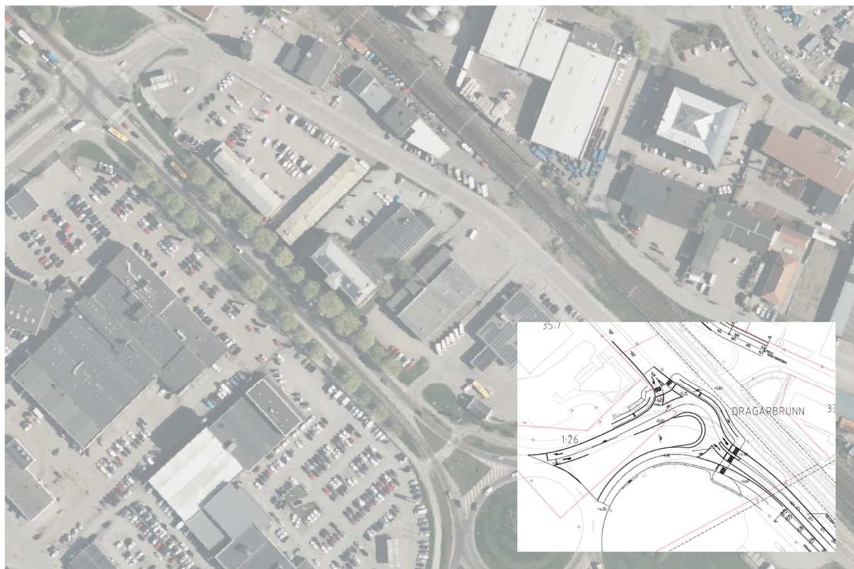
Figur 18. Utformningsalternativ B, i form av påhängsdroppe vid Kuggebrovägen. I detta alternativ finns inte anslutningen vid Kungsgatan med.
