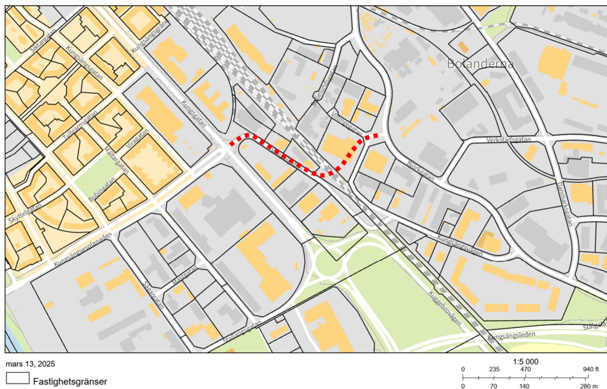
Figur 6. Förordat läge ny bro över Ostkustbanan med tillhörande gata i ytläge i var ände (röd streckad linje) för ersättning av Vimpelgatans plankorsning.
