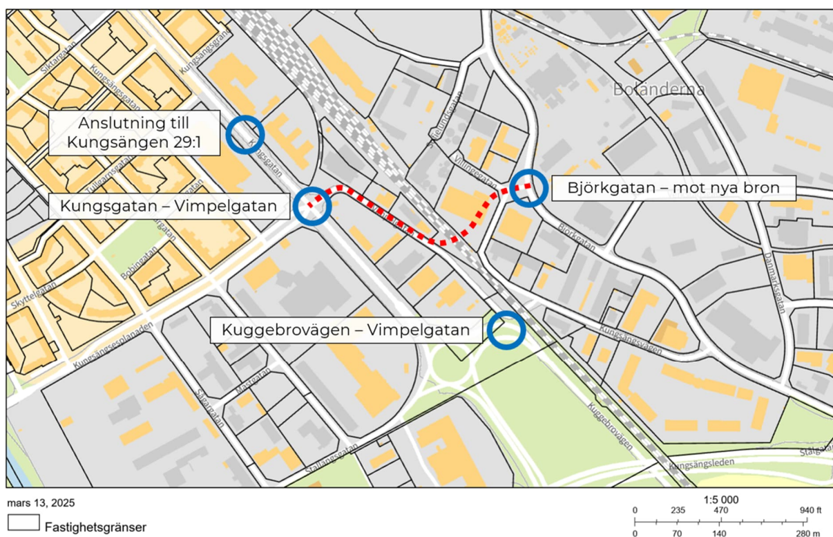
Figur 9. Områden som analyserats med mikrosimulering (blåa cirklar), samt var dessa ligger i förhållande till den planskilda passagen över järnvägen (röd streckad linje).
