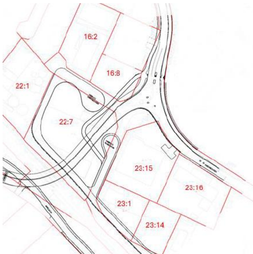
Figur 34. Nya gatusträckningar i Boländerna. Den nya gatan på Boländerna 22:7 utförs som en kvartersgata och planläggs därför inte som allmän plats. Källa: WSP
