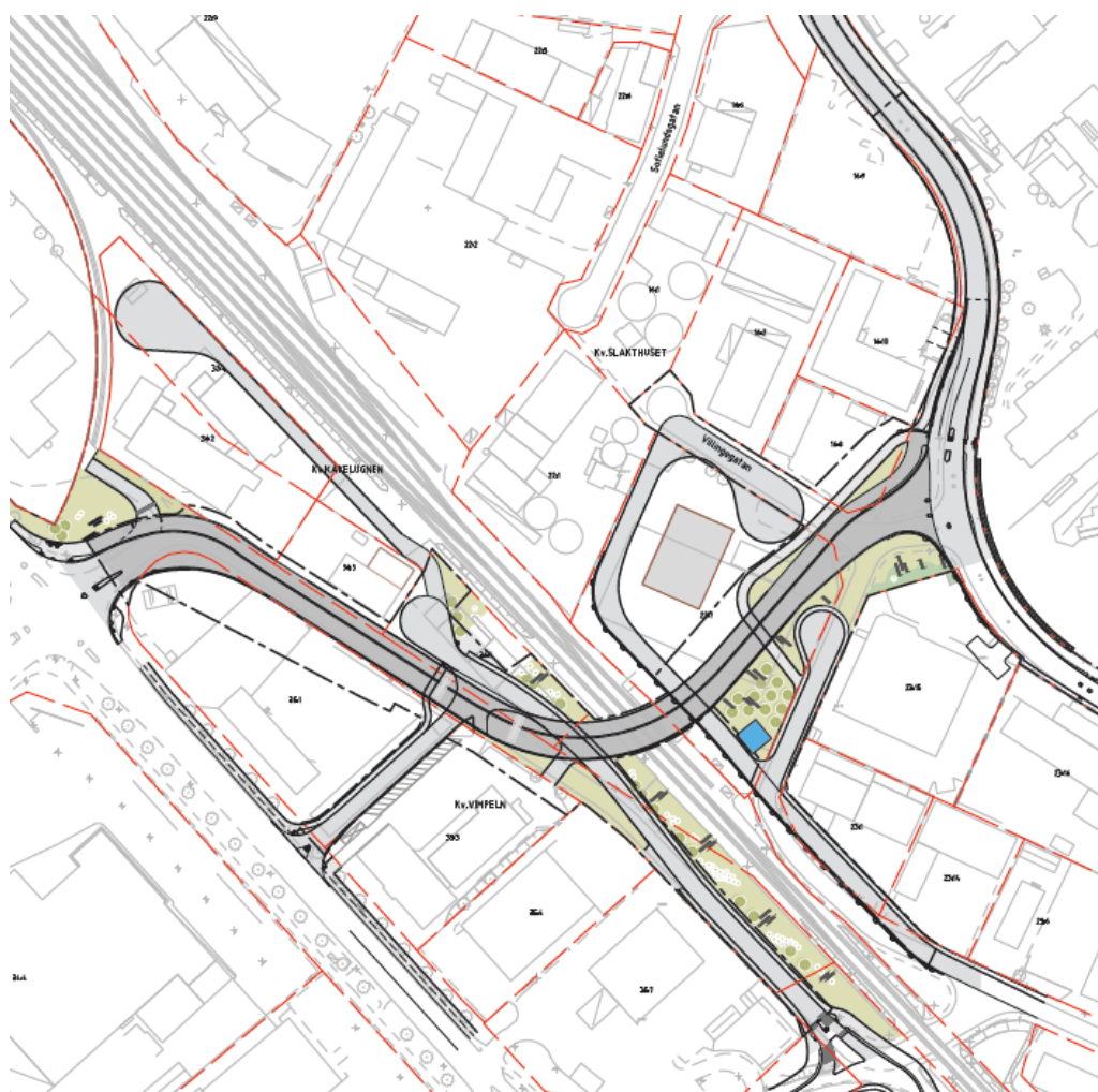
Figur 15 Illustrationsplan som visar nya bron samt närområdet. Svart linje är plangränsen. Källa Bjerking.
