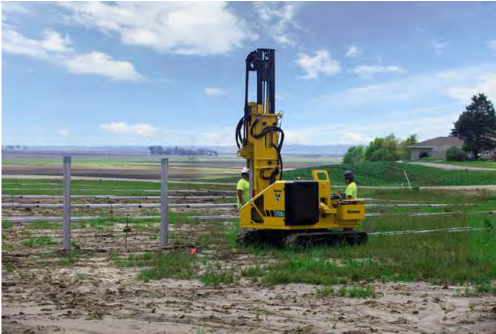
Figur 16-Exempel på pålningsmaskin på larvfötter för installation av pålar för stängsel och markställningar.
