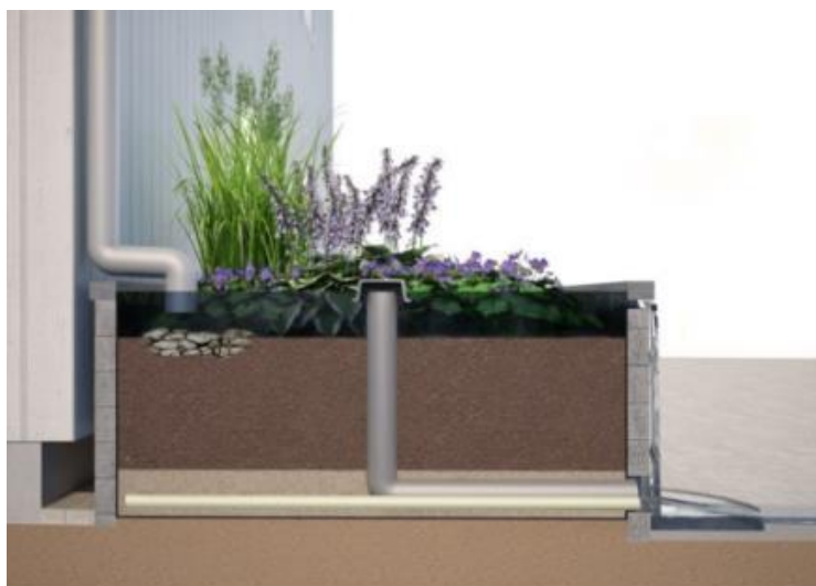
Figur 3. Biofilter med tät botten och dräneringsledning. Bräddavlopp till ledningsnät (Från Vinnovas rapport "Inventering av dagvattenlösningar för urbana miljöer", 2012).
