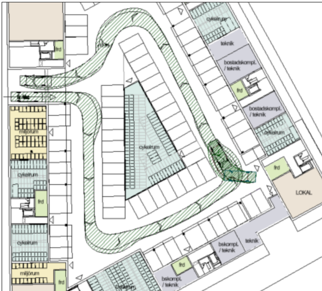
Figur 13. Tillgänglig angöring via garaget med typfordonet Lbm.
