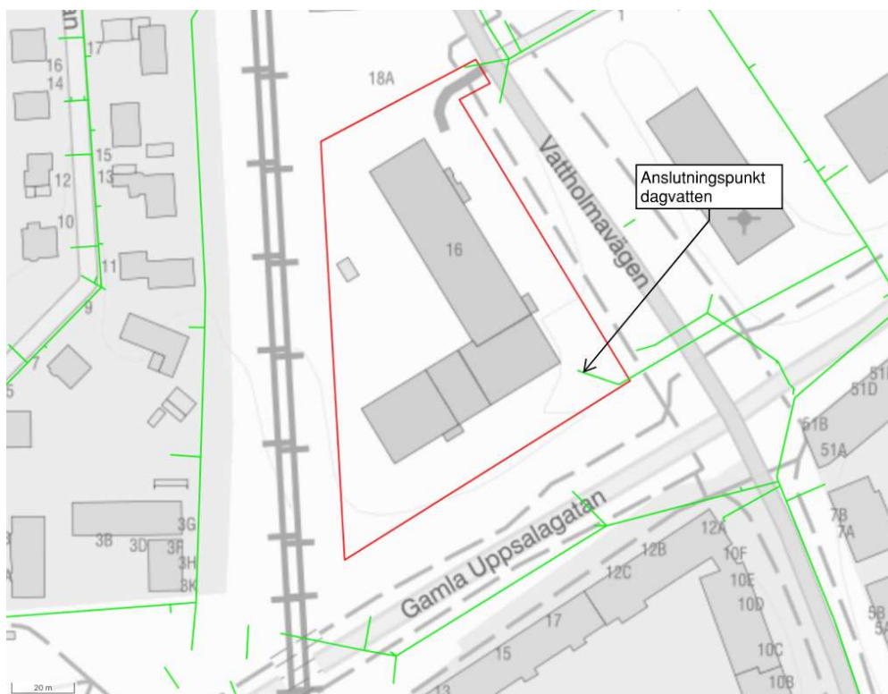
Figur 12. Gröna linjer avser befintligt kommunalt ledningsnät för dagvatten. Planområdesgräns i röd linje. Anslutningspunkt dagvatten markerad med textflagga. Ledningskollen, 2025-10-13.
