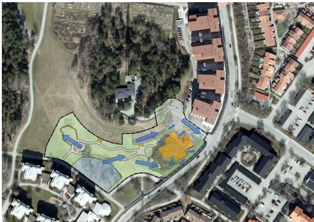
Figur 18 - Flödesriktningar vid skyfall, Rejlers.
