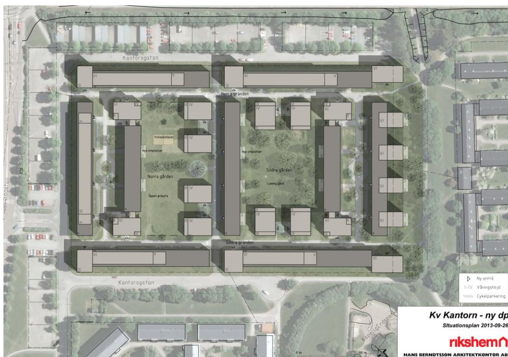
Situationsplan med föreslagna nya byggnader i ljusgrått och befintliga byggnader i mörkgrått. Illustration utförd av Hans Berndtsson Arkitektkontor AB. Observera att norr inte är orienterat uppåt i illustrationen.
