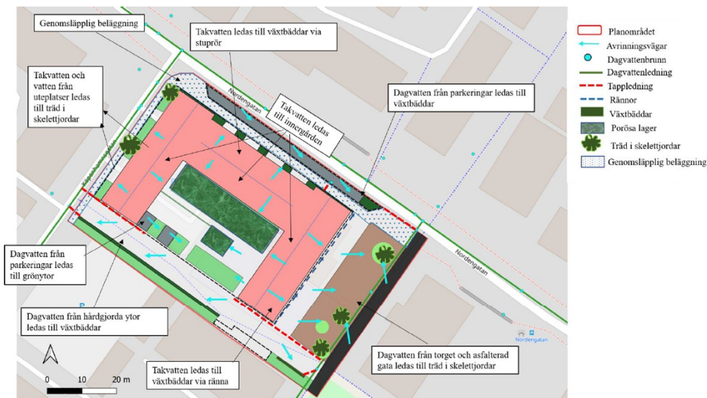
Bild 31 Schematisk skiss på hur dagvattenhanteringen kan lösas inom planområdet med hjälp av en kombination av olika lösningar – växtbäddar, porösa lager på bjälklag, genomsläpplig beläggning och träd i skelettjordar. Illustration: WRS – Water Revival Systems.
