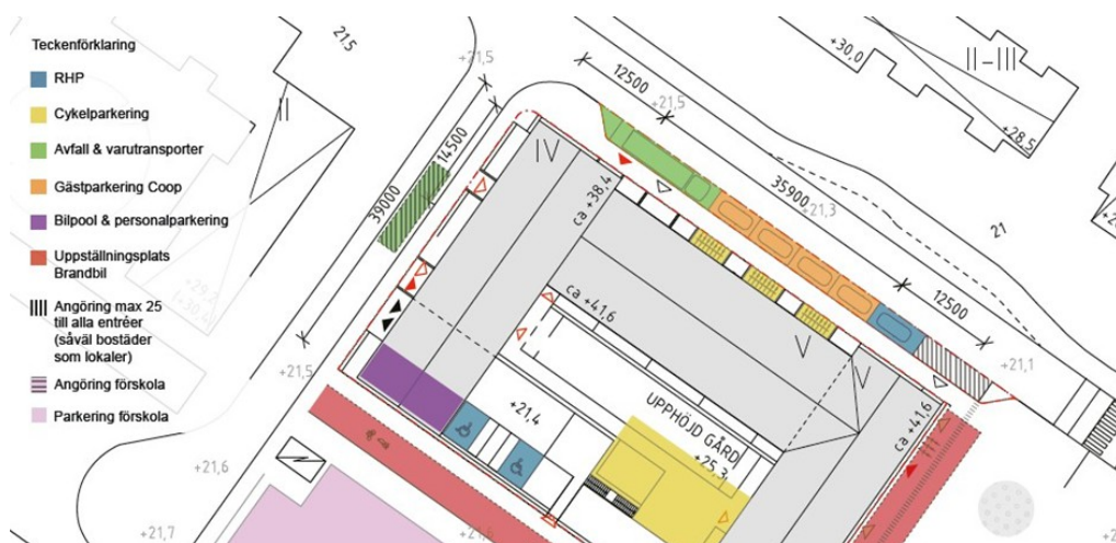
Bild 42 Tilltänkt placering av avfalls- och varutransporter är markerade med grönt. Illustration: DinellJohansson.
