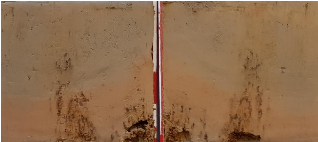
Figur 1 Borrpunkten, 22T02, 4,0 m, Jordprovet i nedre delen av mellanhylsan delad longitudinellt provhylsan med id Bjerking 1176.
