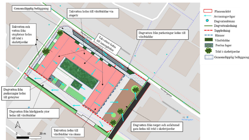
Bild 31 Schematisk skiss på hur dagvattenhanteringen kan lösas inom planområdet med hjälp av en kombination av olika lösningar – växtbäddar, porösa lager på bjälklag, genomsläpplig beläggning och träd i skelettjordar. Illustration: WRS – Water Revival Systems.
