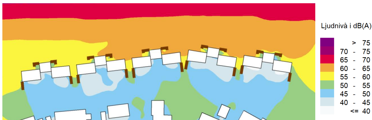
Figur 2. Ekvivalenta ljudnivåer för uteplats. Observera att figuren är roterad. Bullerskyddsskärmar är markerade i brunt.
