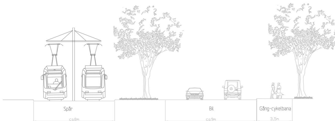
Figur 14. Exempel på utformning av spårväg på egen bana.
