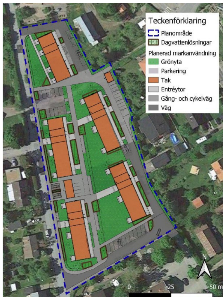
Bild 10 Bilden redovisar förslag på placering och yt-dimensionering av dagvattenlösningar i form av regnbäddar. Illustration: Geosigma.
