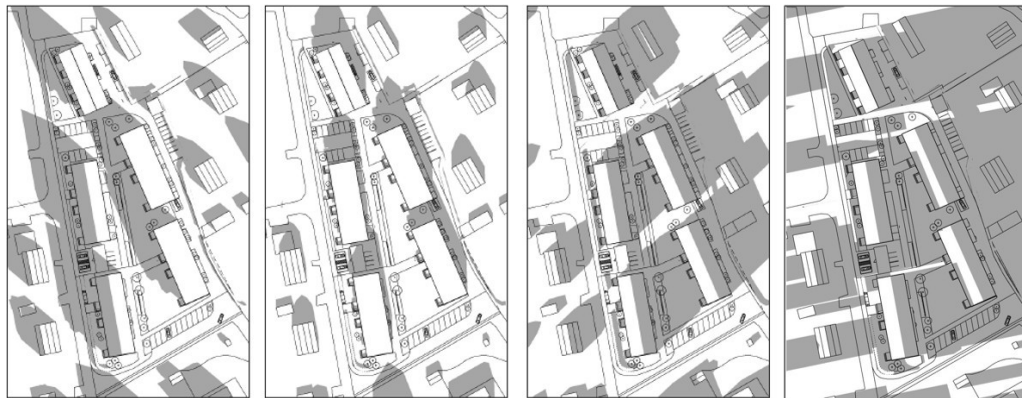
Bild 13 Solstudie under vår- och höstdagjämning, från vänster klockan 9.00, 12.00, 15.00 och 18.00. Illustration: PE projektengagemang.
