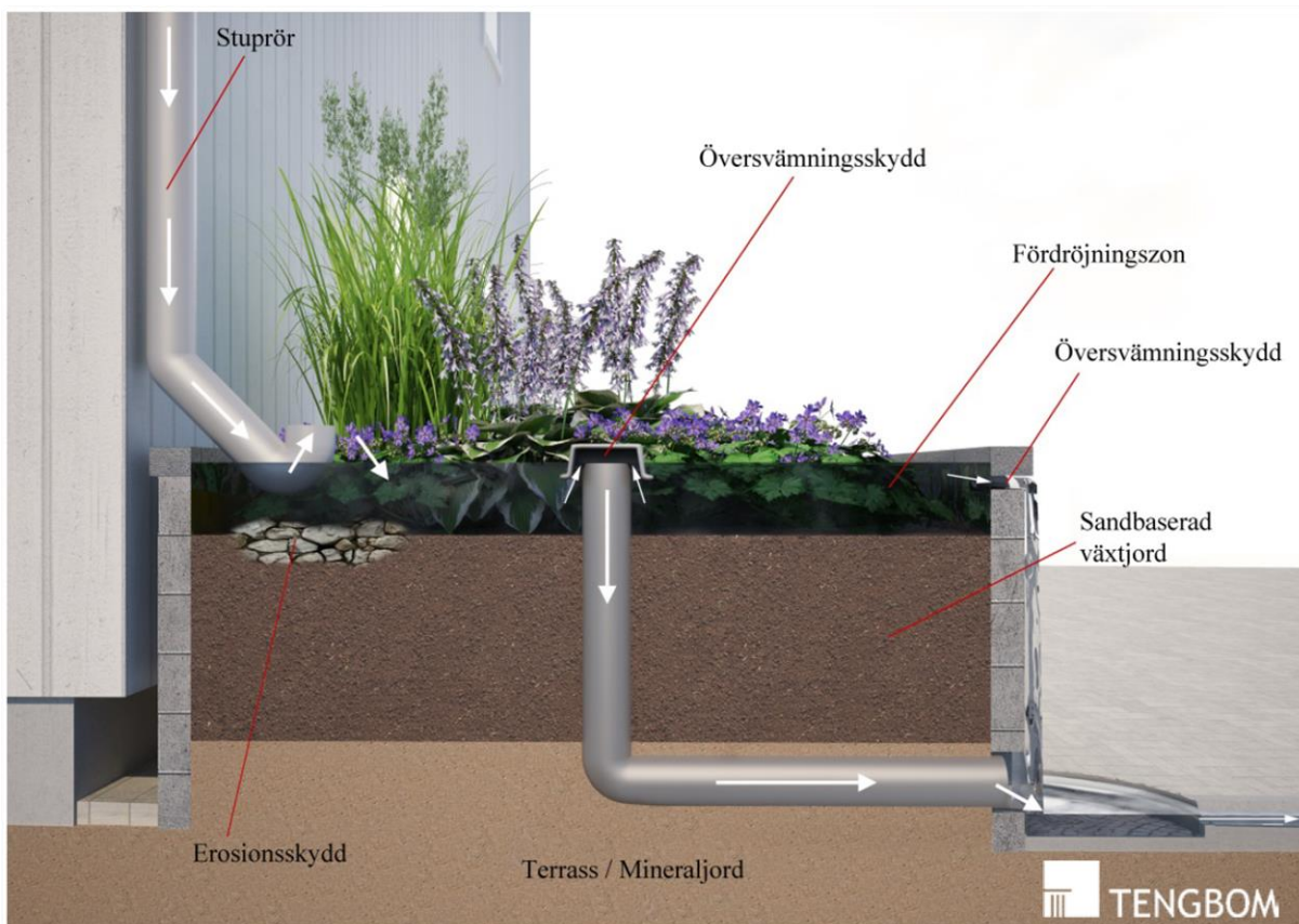
Figur 6-4. Regnbädd/regnbädd i en stenkista placerad intill byggnad vid utkastare från stuprör. Illustration av Kent Fridell 2014.
