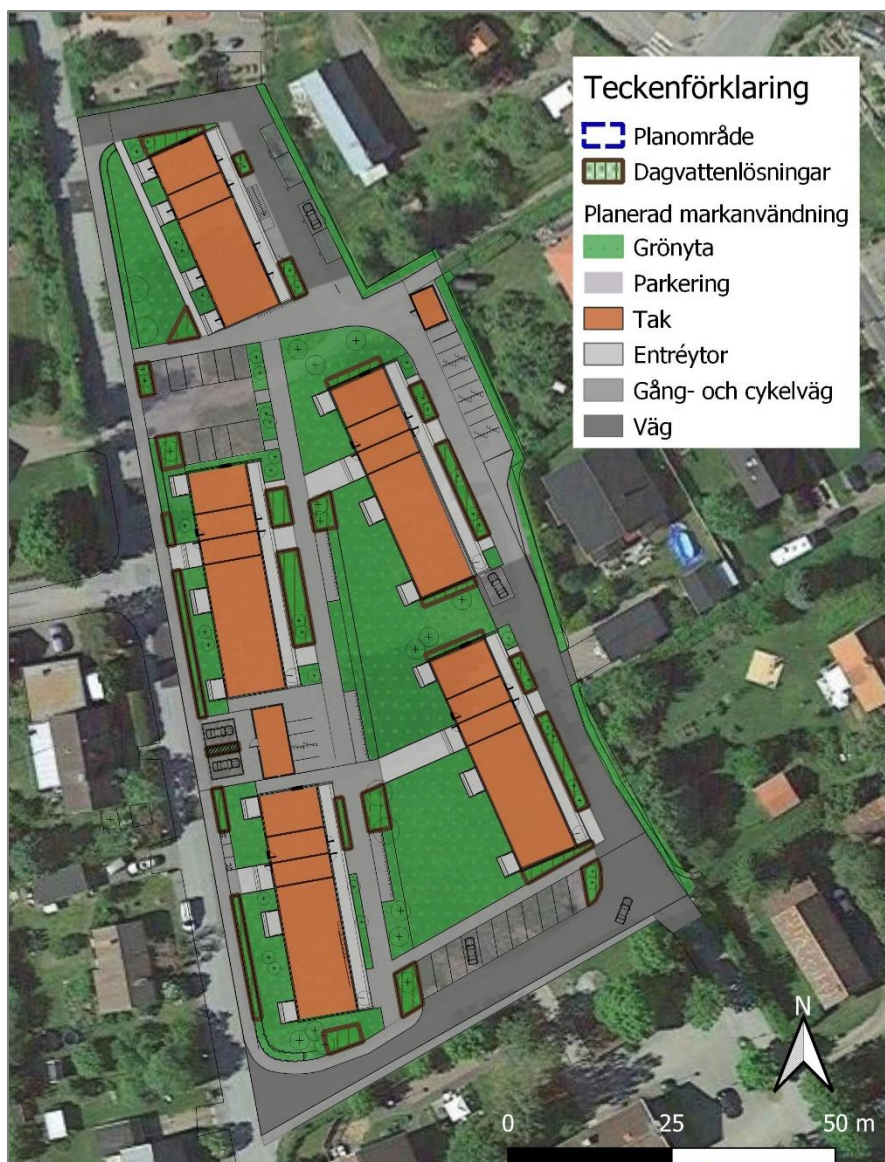
Figur 5-6. Förslag till placering och ungefärligt ytanspråk av dagvattenlösningar i form av de regnbäddar som föreslås inom planområdet.
