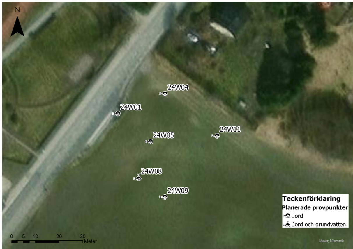
Figur 3. Planerade provpunkter för jord och grundvatten.
