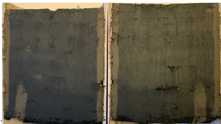
Figur 3 Borrpunkten, BG19003, 4,0 m, Jordprovet i övre delen av mellanhylsan delad longitudinellt provhylsan med id Bjerking 1282.
