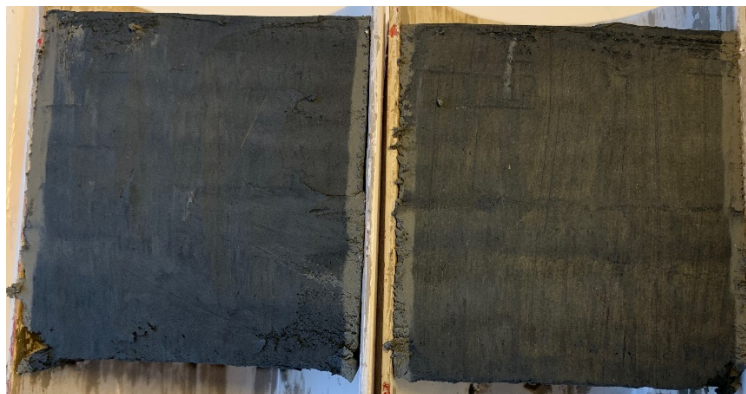
Figur 1 Borrpunkten, BG19001, 5,0 m, Jordprovet i övre delen av mellanhylsan delad longitudinellt provhylsan med id Bjerking 811.
