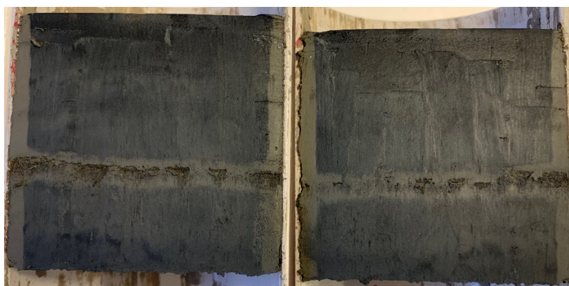
Figur 5 Borrpunkten, BG19003, 9,0 m, Jordprovet i övre delen av mellanhylsan delad longitudinellt provhylsan med id Bjerking 1288.
