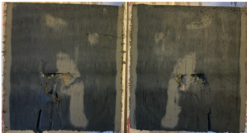
Figur 4 Borrpunkten, BG19003, 6,0 m, Jordprovet i övre delen av mellanhylsan delad longitudinellt provhylsan med id Bjerking 1285.
