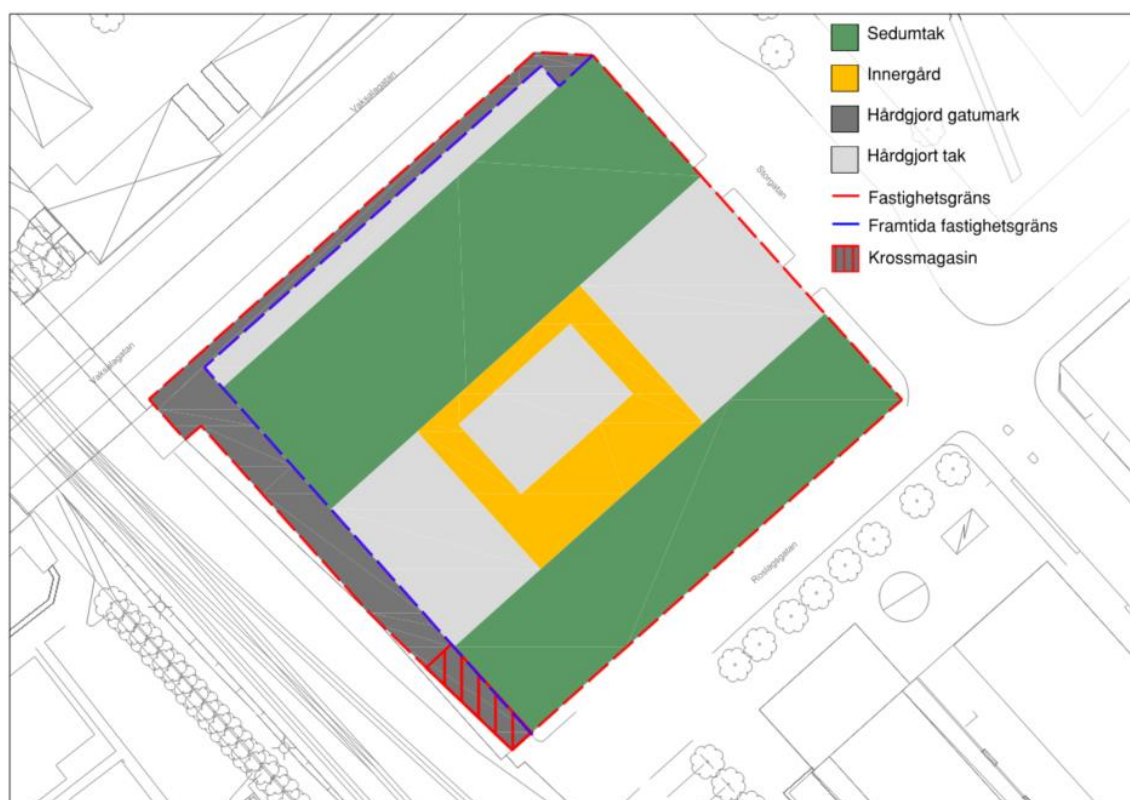
Figur 9. Åtgärdsförslag för fördröjning och rening av de första 20 mm. Sedumtak, grön innergård samt krossmagasin som omhändertar hårdgjorda takytor.
