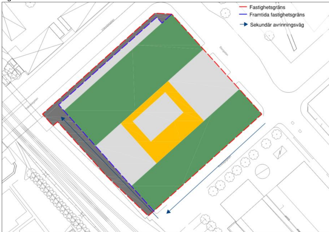
Figur 11. Ny föreslagen sekundär avrinningsväg efter exploatering.
