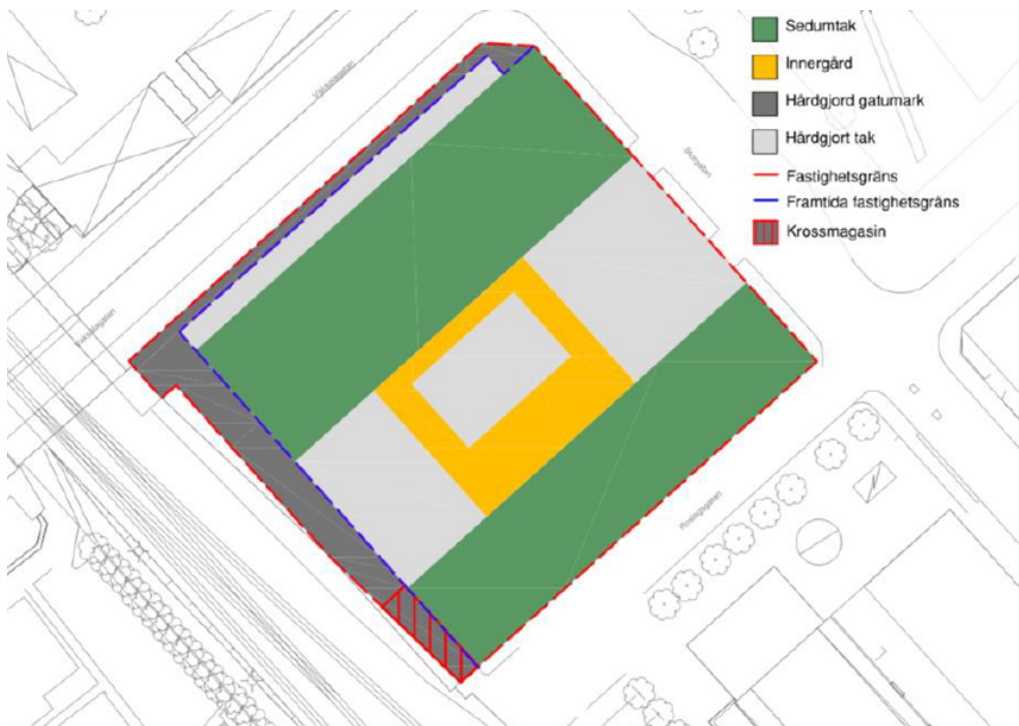
Bild 23 Illustration som visar fördröjningsytor på tak och innergård samt placering av krossmagasin, Bjerking.
