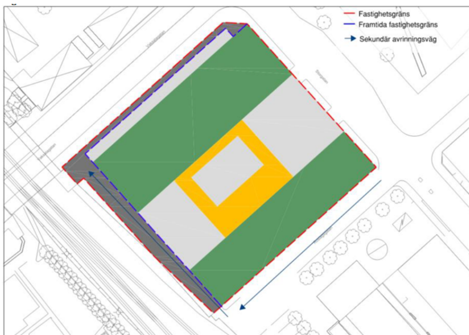
Bild 26 Förslag på ny sekundär avrinningsväg visas med blå pilar, Bjerking.
