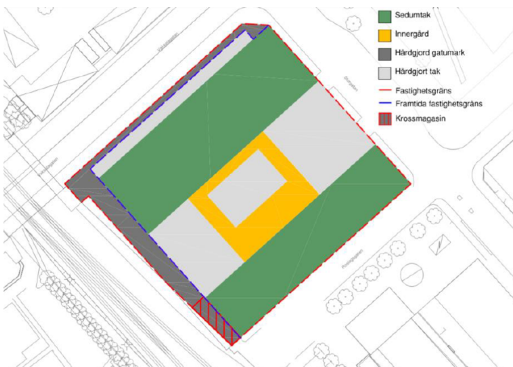
Bild 16 Illustration som visar fördröjningsytor på tak och innergård samt placering av krossmagasin, Bjerking
