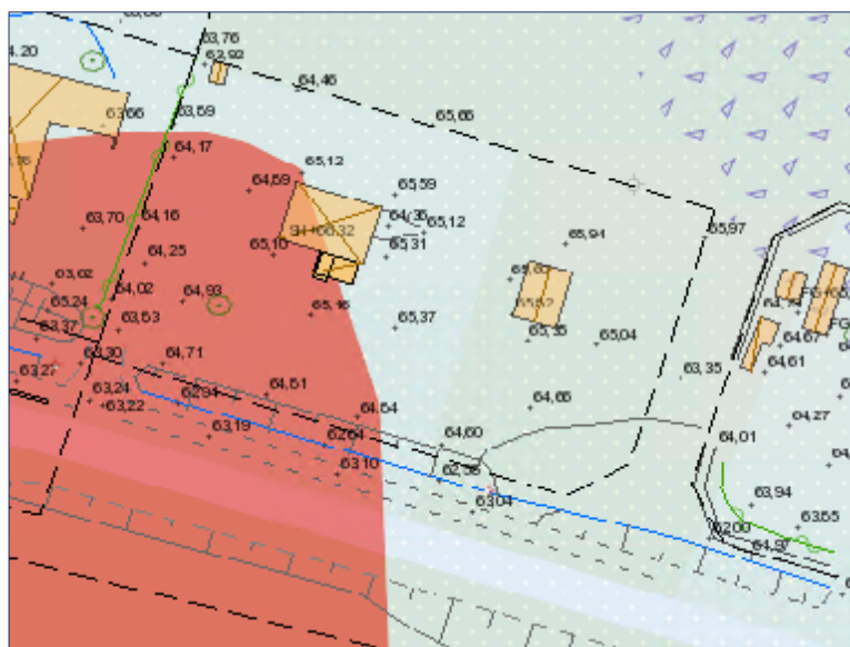
Figur 8 Kartan visar att planområdet består av berg (röd markering) och av sandig morän (grön, prickig markering).
